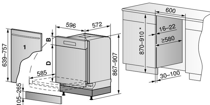
\* Si la hauteur de la niche est supérieure à 910 mm, il est nécessaire de placer une plinthe en dessous ou d'utiliser un panneau décoratif de grande dimension.
