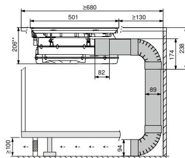
**Recyclage de l'air, sans guidage, avec caisson télescopique court (E\*)**
