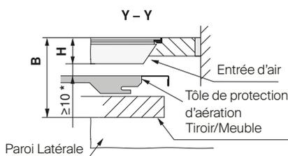
Plaque de ventilation avec profilé pour montage sous plaques FullFlex est absolument obligatoire. Voir accessoires p 46
