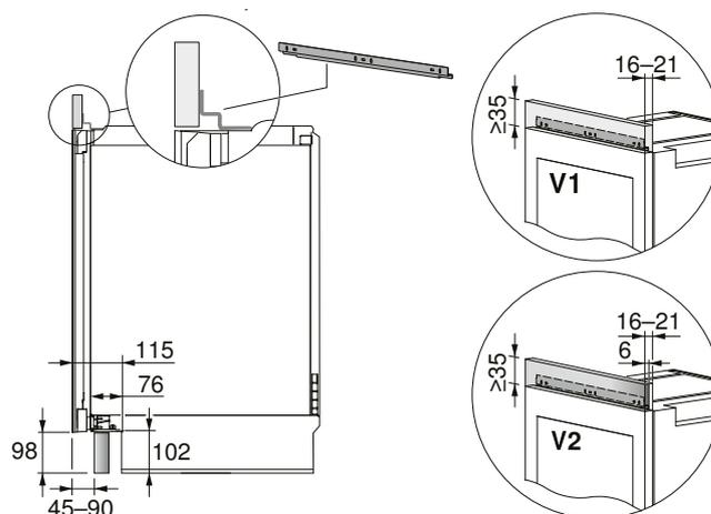
Le séparateur de mousse doit être installé entre la plinthe et l'appareil, sinon la durée de vie de l'appareil sera réduite. Si la plinthe de ventilation est installée au ras de la façade, il faut commander un séparateur supplémentaire (article n° 1084539).
