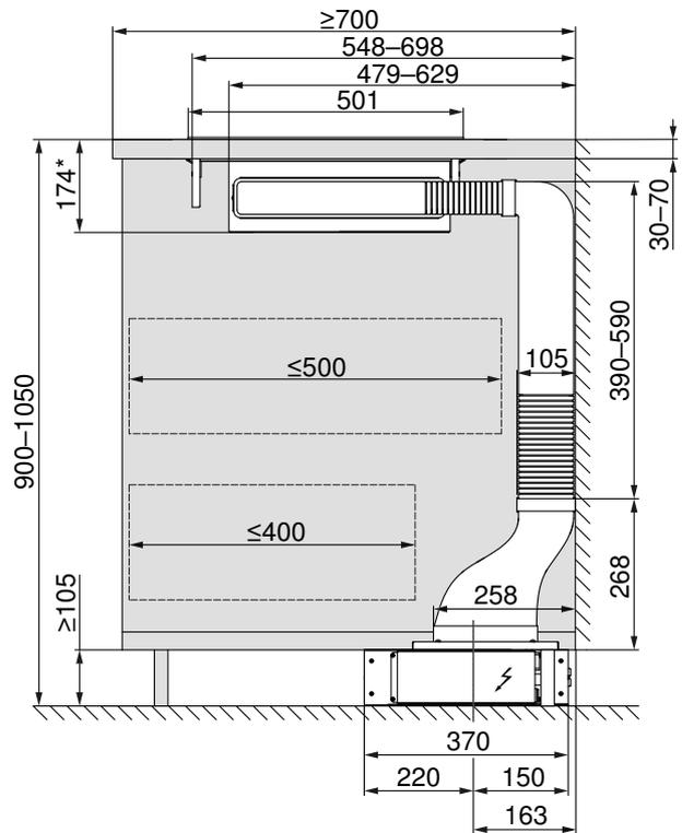
Montage îlot, profondeur  $\geq 900$  mm
