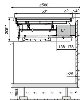
**Recyclage de l'air, sans guidage, avec caisson télescopique long**
