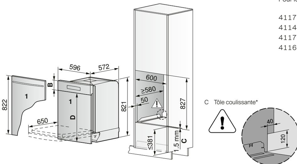
C La plaque de base (article W84789) pour encastrement en hauteur est gratuite, à préciser lors de la commande du lave-vaisselle.
