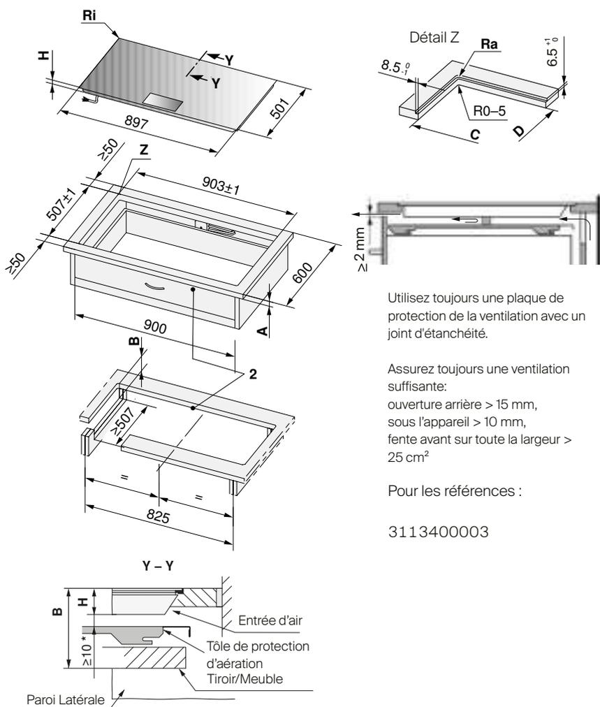
Utilisez toujours une plaque de protection de la ventilation avec un joint d'étanchéité.
