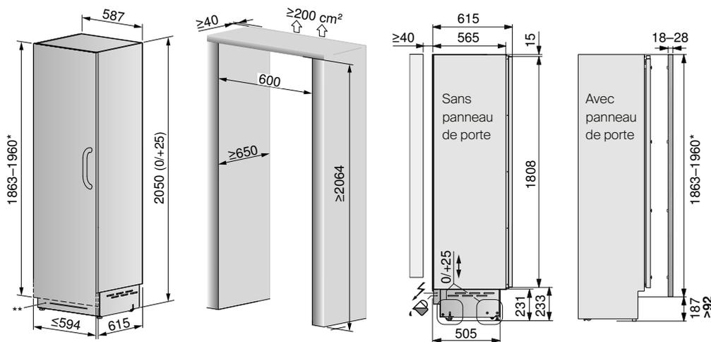
\* Pour une hauteur de niche > 2,064 m, la hauteur de la porte doit être ajustée
