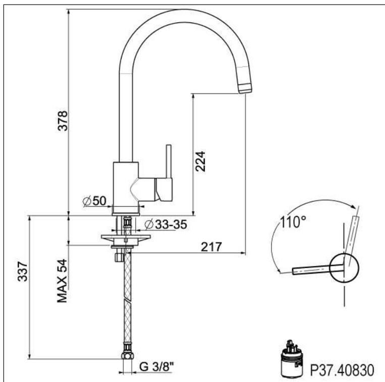
Perçage utile - Kraangat : Ø 35 mm
