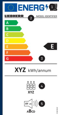
1. Le QR code permettant d'identifier le produit dans le registre européen des produits pour les étiquettes énergétiques (European Product Registry for Energy Labels ou EPREL).
