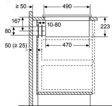
En cas d'installation directement contre des murs extérieurs qui ne sont pas isolés ( $\mu \geq 0,5 \text{ W/m}^2 \text{ °C}$ ), nous recommandons d'utiliser des configurations de recyclage partiellement ou totalement gainées.
