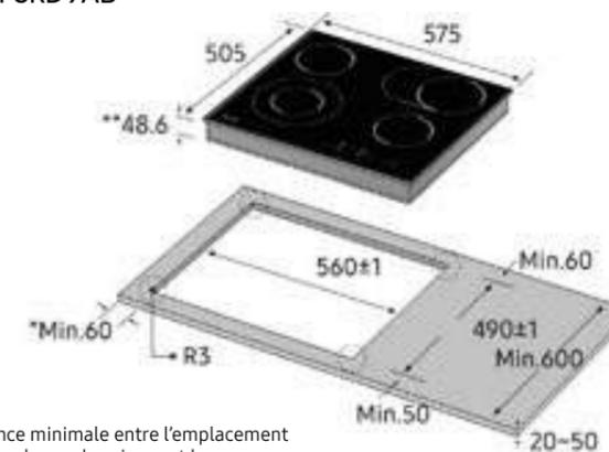
\* Distance minimale entre l'emplacement pour la plaque de cuisson et le mur
